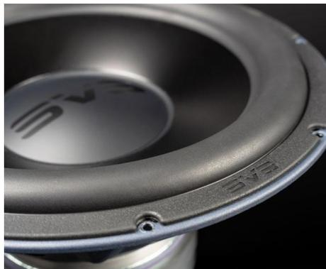
经过完全重新设计的12英寸SVS驱动器可提供无误的准确度和瞬态速度的大规模低频输出。铝质排气锥具有出色的刚度质量比和专有的注模极限偏移环绕,可确保完美的活塞运动,实现完美的控制和精度。
